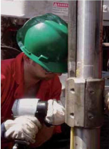
الشكل (10- 11): كبل مقياس ومشبك منصوبين داخل أنبوب (حقوق نشر الصورة لـ H. Crumpton).
