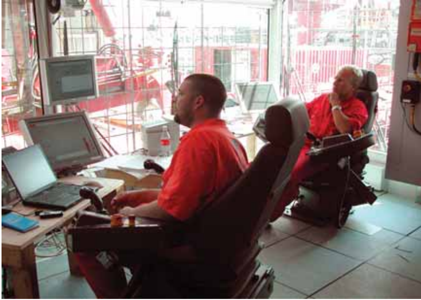
الشكل (4 - 10): يتحكم طاقم منظومة عمل الأنبوب المؤتمت الظاهر خارج غرفة التحكم.
