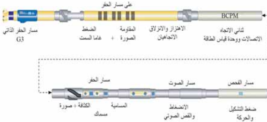
الشكل (6 - 38): أداة التسجيل البئري بنتاكومبو (Pentacombo) صنع بيكر - هيوز.
