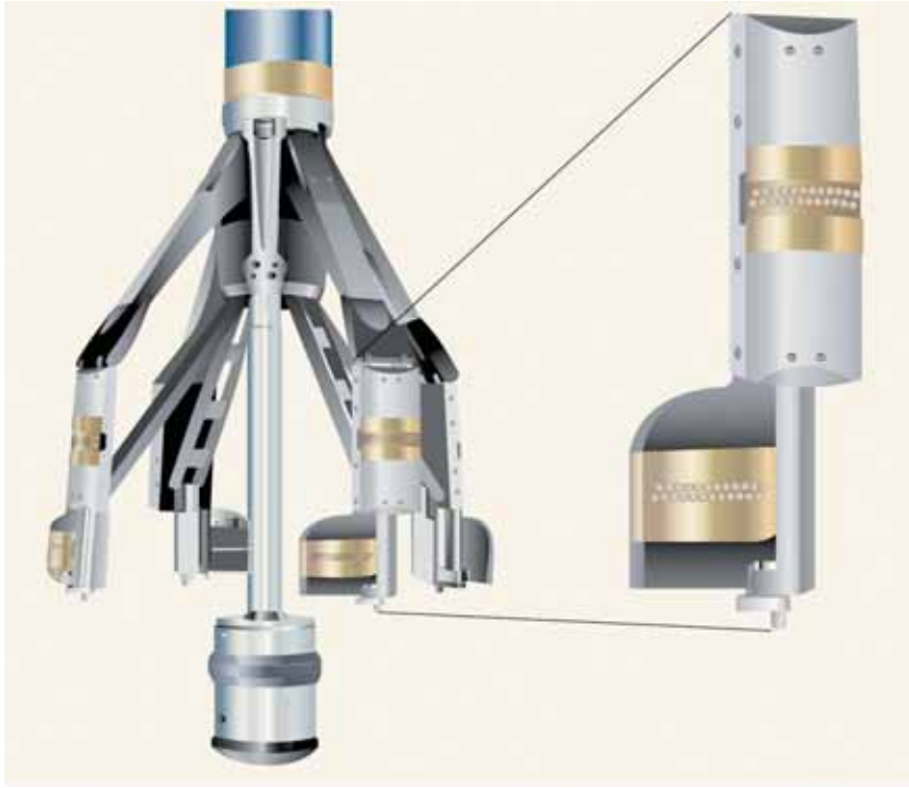
الشكل (6 - 58): أداة شلمبرجيه (FMI) تظهر أذرعاً متمفصلة مع وسائد وأجنحة وأزرار.
