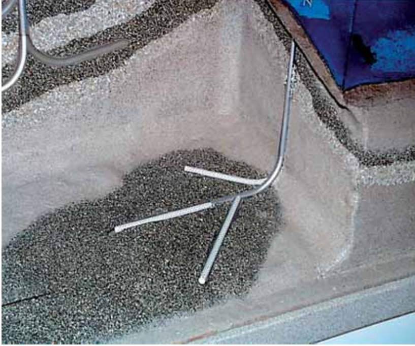
الشكل (4 - 20): نموذج لبئر متعدد الاتجاهات الجانبية لزيادة تماس الخزّان.
